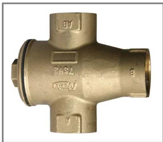
Trojcestný směšovací ventil TSV3 má zabudovanou termostatickou vložku, která zavírá vstup "A" (z topného systému), pokud je vratná voda do kotle (výstup "AB") nižší než jmenovitá. Po dosažení jmenovité teploty termostat pomalu otevírá vstup "A" vratné vody z topného systému tak, aby po smíchání s horkou vodou z výstupu kotle (výstup „B“) bylo dosaženo jmenovité teploty vratné vody do kotle (výstup "AB"). Vstup "B" zůstává vždy otevřený.
