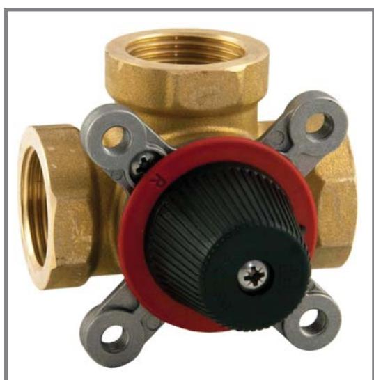
Trojcestný směšovací ventil směšuje otopnou vodu do topného systému na požadovanou teplotu. Ke směšování dochází prostřednictvím rotoru ve tvaru kruhového segmentu. Úhel natočení rotoru, který slouží k regulaci je přibližně  $90^{\circ}$ , odpovídá stupnicí od 0 do 10 (bez zarážek může rotovat  $360^{\circ}$ ).
