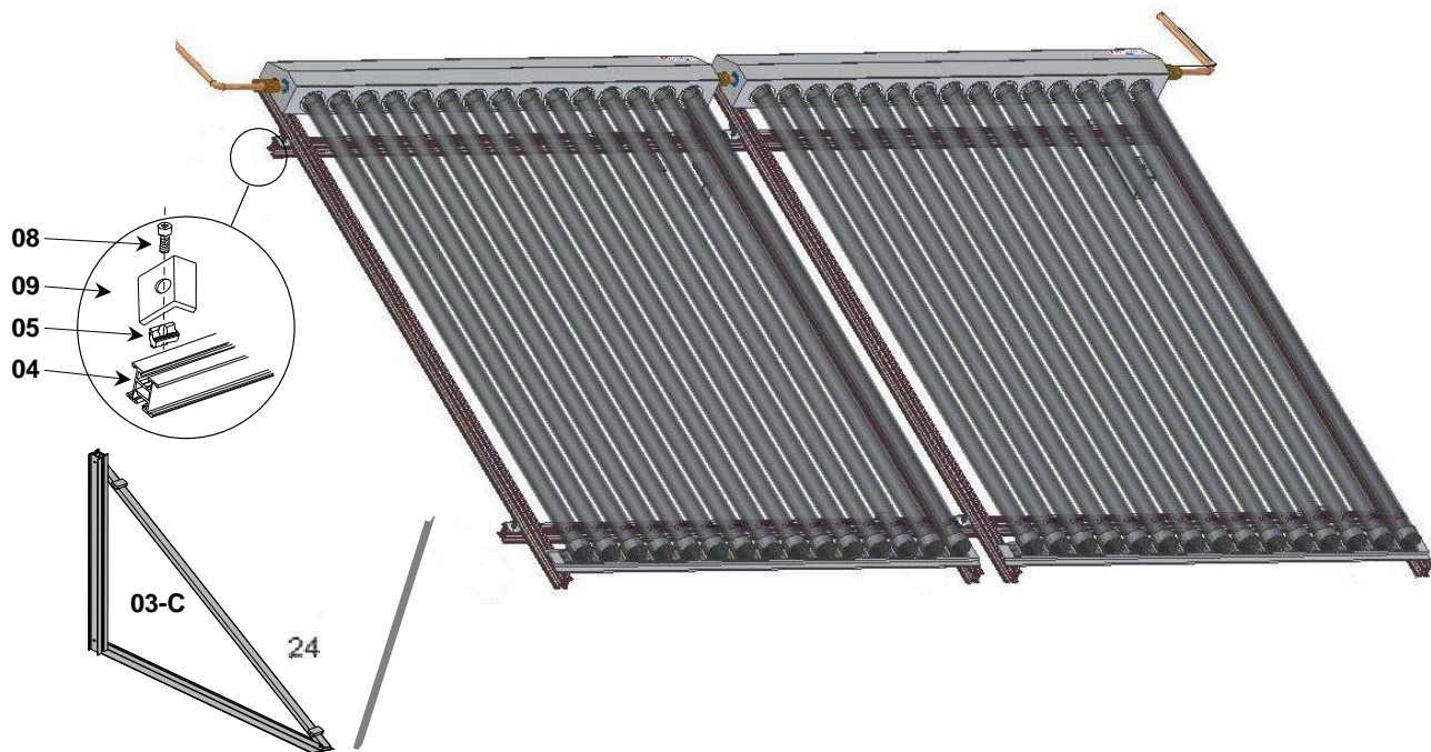
Obr. 15: Trojúhelníková podpěra a zavětrovací vzpěra
